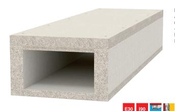
Brandschutzkanal aus wasser- und frostbeständigen Glasfaserleichtbeton der Baustoffklasse A1 gemäß EN 13501-1 zur brandsicheren Verlegung von Kabeln in Flucht- und Rettungswegen und zum Funktionserhalt sicherheitsrelevanter Anlagen. Klassifizierung 190 als I-Kanal gemäß DIN 4102 Teil 11 und Klassifizierung E30 als E-Kanal gemäß DIN 4102 Teil 12. Montage des Kanals direkt an Wänden oder unter Decken. Inklusive Senkkopfschrauben und Dichtungsstreifen.
