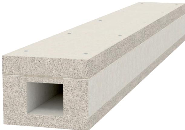
Brandschutzkanal aus wasser- und frostbeständigen Glasfaserleichtbeton der Baustoffklasse A1 gemäß EN 13501-1 zur brandsicheren Verlegung von Kabeln in Flucht- und Rettungswegen und zum Funktionserhalt sicherheitsrelevanter Anlagen. Klassifizierung I90 als I-Kanal gemäß DIN 4102 Teil 11 und Klassifizierung E30 als E-Kanal gemäß DIN 4102 Teil 12. Montage des Kanals direkt an Wänden oder unter Decken. Inklusive Senkkopfschrauben und Dichtungstreifen.
